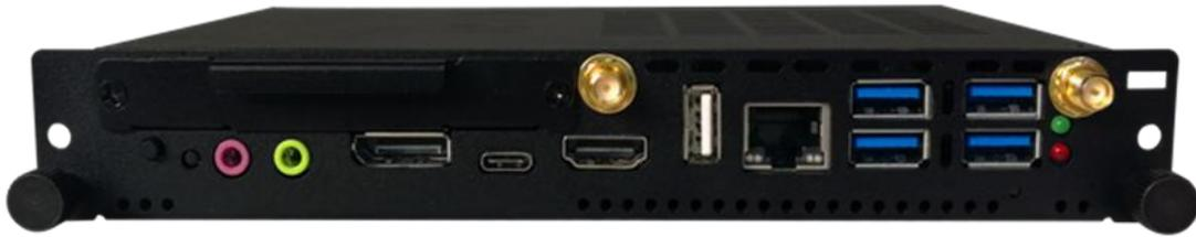
Все панели Newline оборудованы стандартным разъемом Intel OPS 80 pin. Данный разъем используется для установки опционального встраиваемого компьютера на базе обычного процессора, памяти и SSD-диска с Windows 10 на борту, что превращает интерактивный дисплей Newline в моноблок, в который может быть установлено любое привычное пользователю Windows-приложение, от образовательных программ до сложных систем просмотра и редактирования 3D-моделей.
